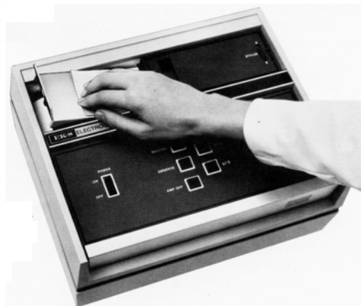
Figura LD-7:5: Instrucciones para colocar el Papel en la Máquina Burdick EK-8. Aquí se ilustra los pasos a seguir para insertar el papel de EKG en el electrocardiógrafo.
